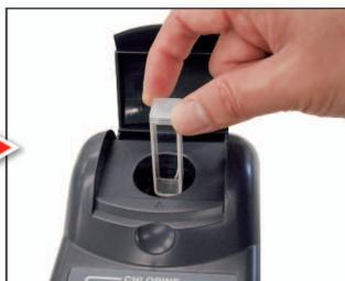
測定部に測定セルをセットします。
