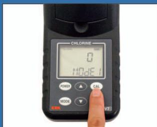
ゼロ校正水を入れた測定セルを計器にセットしゼロ校正をします。
