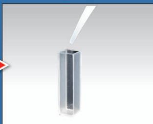
測定セルに試料水、約5mL程度採取して、キャップを取付けます。
