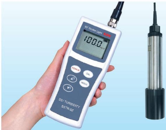
高感度受光素子で高感度SS検出、又、近赤外LED、可視光カットフィルター付で外部光や着色の影響をカット、ノイズに強く安定した測定を保證。
