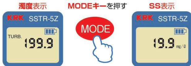
排水の浮遊物質(SS=Suspended Solid)と散乱光濁度は一定の相関関係があります。本器はSSと散乱光濁度との相関係数 $y=a+bx$ を求めてこの係数を設定することで濁度がSS濃度に換算されてSSモードでSSを、濁度モードに切換えると濁度をそれぞれ高感度で測定できます。
